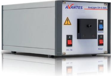
AvaLight-DH-S-BAL 是一款高功率氙 - 卤素组合光源，但就像任何非均衡氙 - 卤素光源一样也在 656 nm 处存在着非常强的阿尔法峰。这就是 Avantes 公司研发 AvaLight-DH-S-BAL 均衡型氙卤素光源的原因，利用一块二向色滤光片大大减弱了 656 nm 处的强度，尽管降低了光源的总功率，但使动态范围增加了 20 倍。
