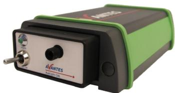
AvaLight-CAL 是一款波长校准灯。它可以给出从 254 nm 到 922 nm 的所有汞和氩的特征谱线。主要谱线和结构包括它们的相对强度都贴在光源的下表面上。通过标准 SMA 905 接头, 该光源可以快速地与光纤连接, 因此可以非常容易地对光纤光谱仪进行波长定标。
