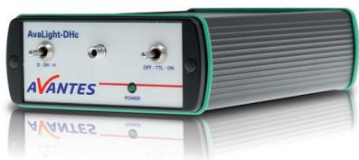
AvaLight-DHc 是一款紧凑型氘-卤素灯组合光源，对于几乎所有化学吸光度应用在 200 到 2500 nm 提供足够的光功率。氘灯的输出从 200 到 550 nm，然后卤素灯会延续到 2500 nm。通过 SMA 接口可以方便地与实验室的其他光谱仪器连接。
